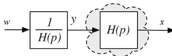
Mais la fonction de transfert réelle  $H(p)$  varie en fonction du point de fonctionnement et les systèmes réels sont soumis à des perturbations. De plus pour certaine fonction de transfert (retard),  $H^{-1}(p)$  n'existe pas. On utilisera ce type de commande uniquement si la mesure de la grandeur réglée est 'difficile' et le système 'facilement modélisable'.
